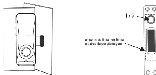
1. Instale a fechadura principal, feche a porta e marque a posição da lingueta da fechadura
